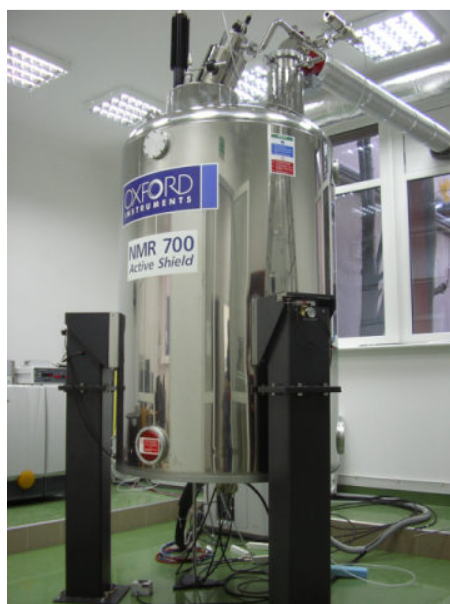
Rysunek 7. Spektrometr NMR. Cienkościenna probówka szklana zawierająca roztwór badanej substancji umieszczana jest wewnątrz pomiędzy magnesami i poddawana jest działaniu promieniowania radiowego (RF) [5].
